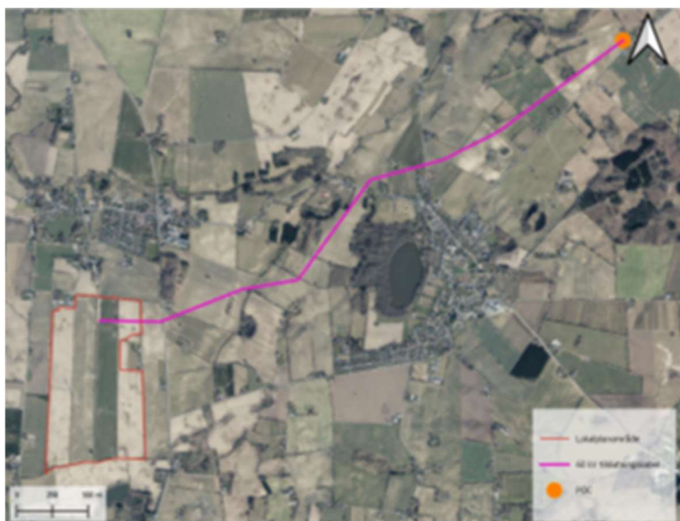
Figur 2. Kort over forventet kabeltracée til nettilslutningspunkt.
